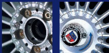
Raffinierte Technik: Der Zugang zum Zylinderschloß erfolgt durch Wegdrehen des ALPINA Emblems, das Ventil ist im Radnabenbereich integriert
